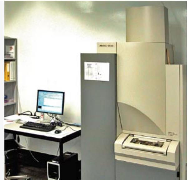
David Drissner, mittels Massenspektrometrie-Analyse (MALDI-TOF/TOF) nachzuweisen, dass diese Flecken Syringasäure enthalten. Syringasäure entsteht durch eine alkalische Reaktion aus Malvidin-3-glucosid, welches die wesentliche farbgebende Substanz blauer Trauben darstellt.
