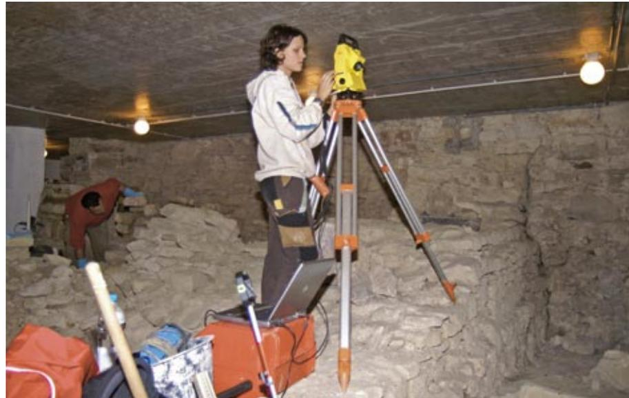
Mehr als ein «cooles Outfit»: die Spezialbrille erlaubt, den Laserstrahl des Tachymeters auch bei Tageslicht zu sehen.
