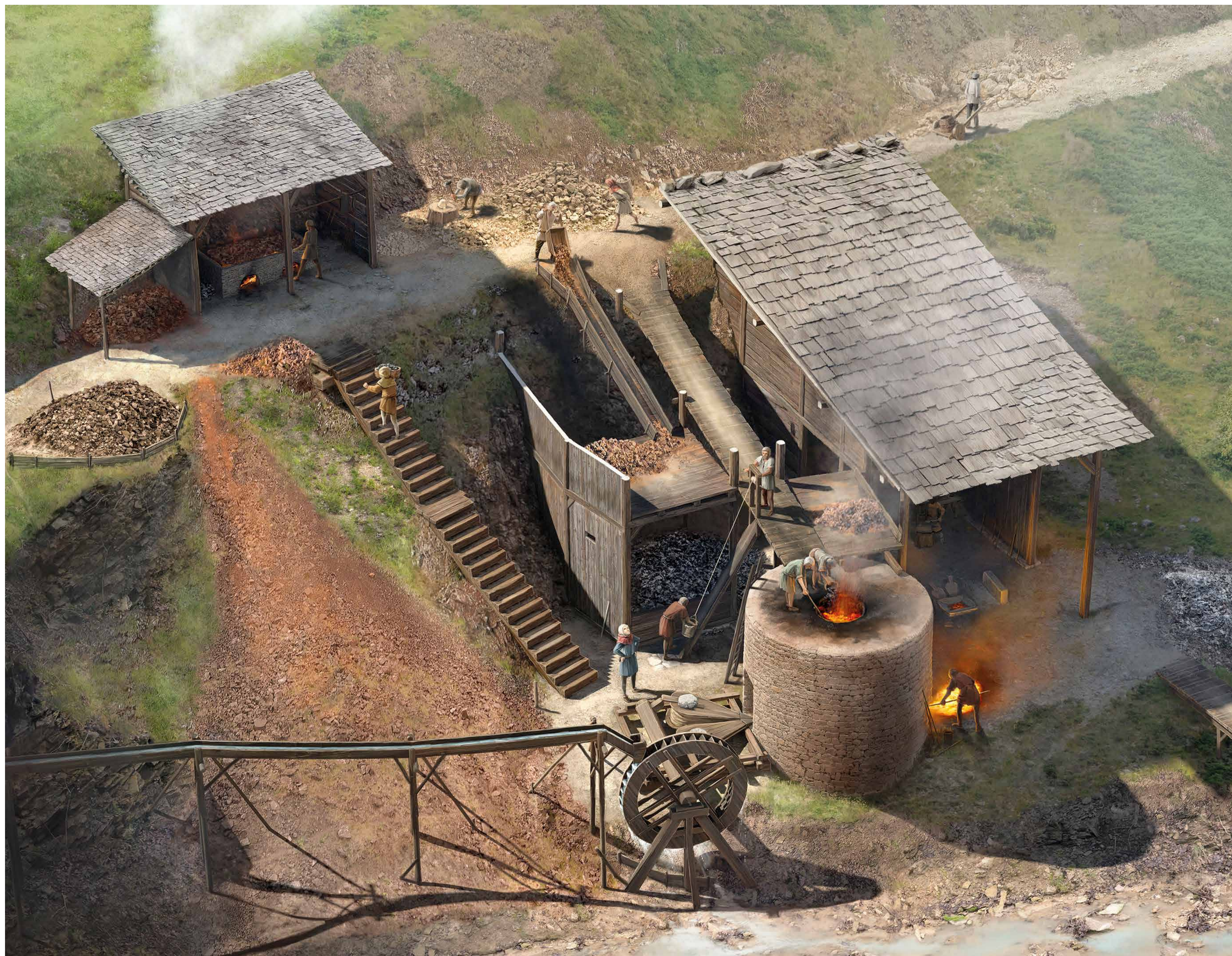
Rekonstruktion der Einrichtungen um Ofen II. Oberhalb des Hochofens befanden sich einfache Holzgebäude, in denen das Erz aufbereitet, die Holzkohle gelagert und das Roheisen weiterverarbeitet wurden. Das Dach im Vordergrund wurde zum besseren Verständnis entfernt. Rekonstruktion: Joe Rohrer, bildebene.ch.
